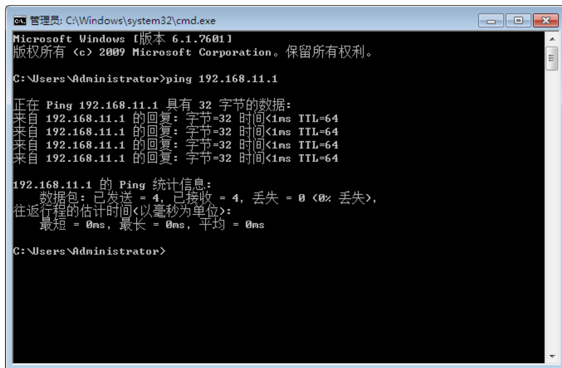
图 4.1-3 ping 测试连通性
